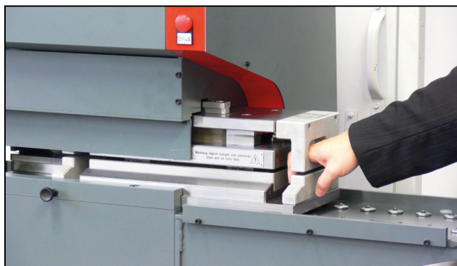
Schneller Wechsel der Stanzwerkzeuge durch die Tischverbreiterung zum M-Cut 65
