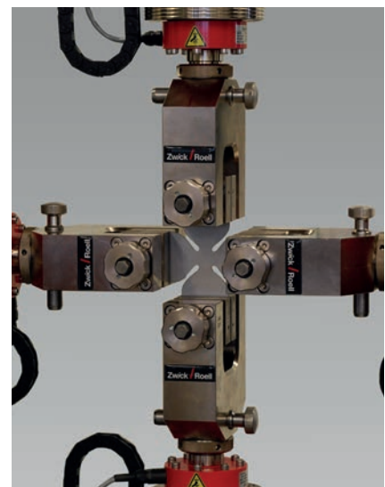
Fig.2: Biaxial tensile test
